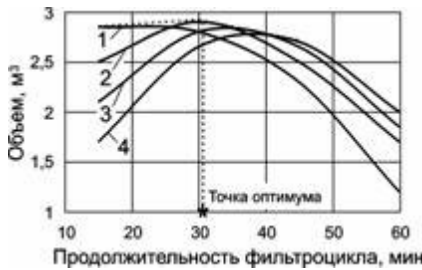
Рис. 5. Определение оптимальной продолжительности промывки для разной продолжительности фильтроцикла продолжительность обратной промывки, с: 1 - 15; 2 - 30; 3 - 45; 4 - 60; пунктир - оптимум
